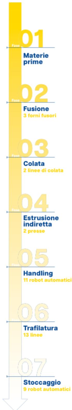
Il processo inizia con la **fusione del metallo** nel reparto fonderia, che si compone di una linea di colata continua per la produzione di billette e di due impianti per la produzione di bandelle di bronzo e leghe speciali.
